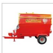
Afbeelding 3: voorbeeld caravaggi mengwagen, geschikt voor organische reststromen
