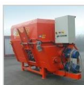
Afbeelding 3: voorbeeld caravaggi mengwagen, geschikt voor organische reststromen
